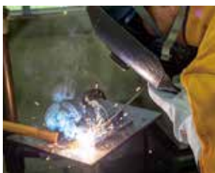
被覆アーク溶接作業
